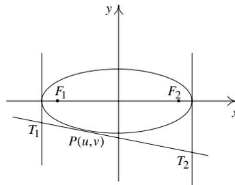
Primero, determinamos las coordenadas de  $T_1$  y  $T_2$ , intersecando la ecuación de la tangente en  $P$ , que está dada por  $b^2ux + a^2vy = a^2b^2$  con  $x = \pm a$ , de donde resultan:  $T_1\left(a, \frac{b^2}{v}\left(1 - \frac{u}{a}\right)\right)$  y  $T_2\left(-a, \frac{b^2}{v}\left(1 + \frac{u}{a}\right)\right)$
